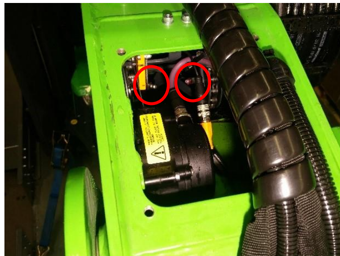
Kuva 17 Levykimppuketjun rasvauskohdat yläpuomin etupäässä
